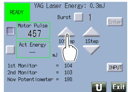
5) Press [Input] to save the parameter for “Motor Pulse”
